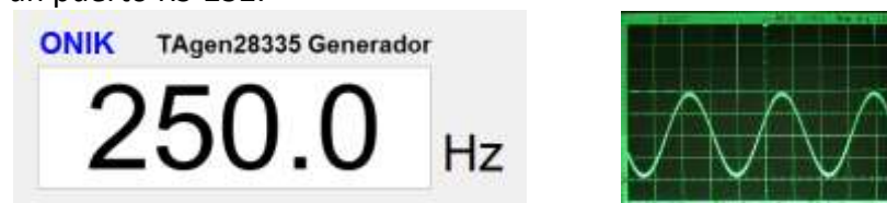
Figura: Interfaz del generador y señal generada vista en un osciloscopio.
