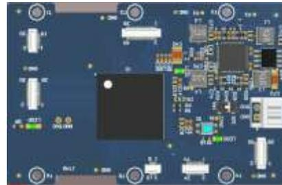
De manera similar a la tarjeta con DSP, esta es una tarjeta que sirve como plataforma de desarrollo para un sistema mayor, incluyendo todo lo necesario para el funcionamiento del FPGA en encapsulado BGA (alimentación, sistema de reloj, interfaz de programación, etc.), así como conectores de expansión para acceder a la mayoría de las terminales del FPGA. El diseño es un PCB de 8 capas, de dimensiones de 5 x 7 cm.
